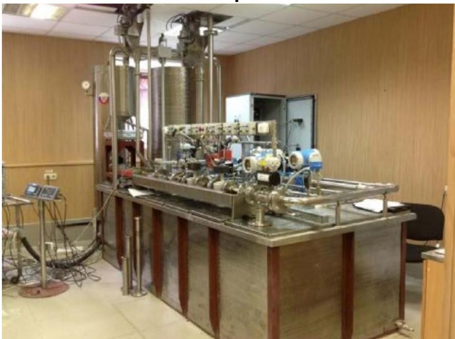
Установки поверочные УПР-50 предназначены для воспроизведения объемного и массового расхода жидкости.
